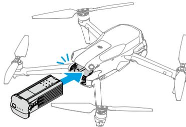
Drücke auf die Akku-Verriegelung, um den Akku aus dem Fach zu entnehmen.
