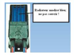
La capacité maximum du **PowerBox Sensor** est décrite dans la nomenclature (3 à 5 A), mais notez que cela n'indique pas forcément les performances max du régulateur de tension intégré au **PowerBox Sensor** installé, qui sont dépendantes de l'efficacité de refroidissement mise en place. Pour effectuer un bon refroidissement (et par conséquent de haute performance) nous avons fixé un radiateur optimisé anodisé bleu à l'arrière du **PowerBox Sensor**.
