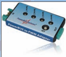
Best.Nr. 9200 - PowerBUS to PWM Adapter 4- fach Verteiler BUS/PWM Wandler integriert
