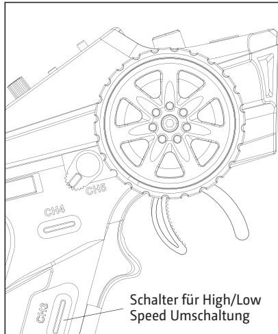
Kanal 3 (CH3) High/Low Speed Umschalter. Ist die LED aus, befindet sich das Fahrzeug im High Speed Modus.
