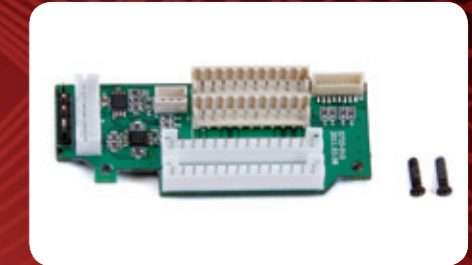
Schnittstellenverteiler HoTT für mc-19/22 und mx-24/mc-24 Best. Nr. 33305 Abmessungen: 61 x 22 x 10 mm
