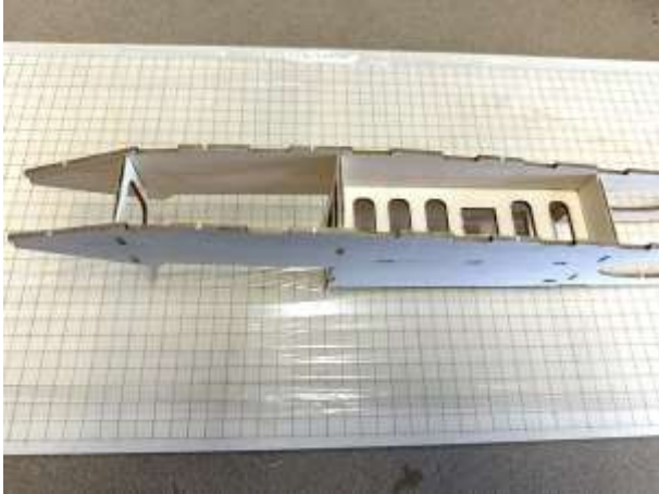
Rumpf umdrehen und Spant F7 einsetzen.
