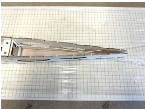
Bowdenzugrohr durch den Rumpf führen und festkleben. Servoseitig etwa 10mm am Spant F6 überstehen lassen.
