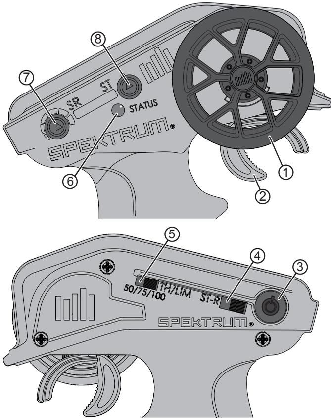
1. **Volant Contrôle** la direction (gauche/droite) du modèle
