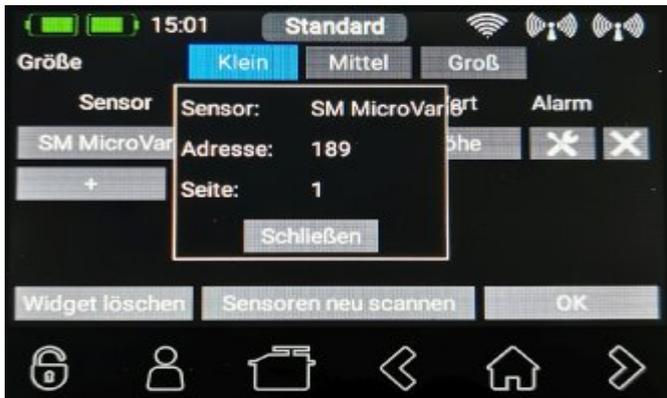
Ein langer Klick auf den Sensor im Widget zeigt auch die Adresse des Sensors. Diese kann mit X→Y auch geändert werden, um mehrere gleiche Sensoren anschließen zu können.
