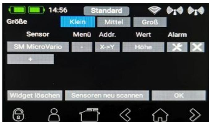
In diesem Widget können auch mehrere Werte im Wechsel angezeigt werden, einfach mit + einfügen.
