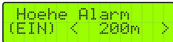
Mit einem weiteren Tastendruck auf ▼ kann der gewählte Wert dann geändert werden (Tasten ◀ und ▶).
