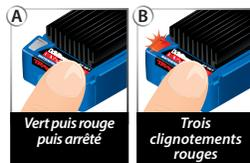
4. Le témoin DEL clignote et puis devient vert constant (le détecteur de basse tension est ACTIVÉ) ou rouge constant (le détecteur de basse tension est DÉSACTIVÉ). Le modèle est prêt à conduire.
