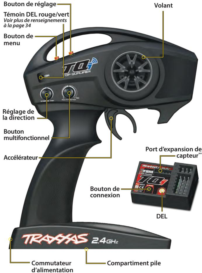
\*\* Port de capteur accessoire à utiliser avec l'extenseur de télémétrie (voir plus de renseignements sur Traxxas.com et dans les matériels fournis)
