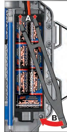
Installez le bloc pile avec les fils orientés vers l'arrière du modèle. Insérez les onglets du dispositif de retenue de la pile dans le collier de retenue arrière (A). Balancez le dispositif de retenue de la pile vers le châssis et mettez en place (verrouillez) l'extrémité dans le collier de retenue avant (B).
