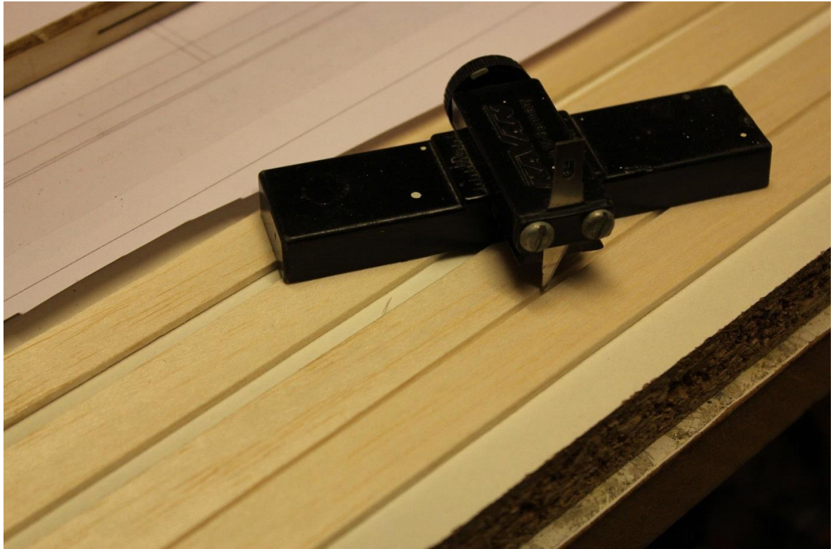
Een lattensnijder is hierbij erg handig Ein Lamellenschneider ist hier sehr nützlich
