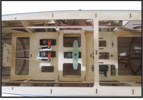
RUDDER PUSHROD INSTALLATION
