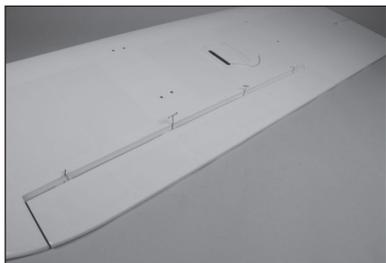
6. Vérifiez l'écart entre l'aile et l'aileron aux deux extrémités. Ajustez pour que l'écart soit identique.
