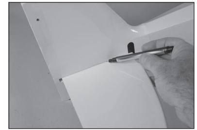
62. Munissez-vous d'une règle et coupez soigneusement l'entoilage de 3 mm (1/8 po) à l'intérieur de la ligne tracée sur le stabilisateur pour retirer l'entoilage du centre du stabilisateur. Retirez l'entoilage supérieur et inférieur. Faites attention à ne pas découper la structure en bois, car cela pourrait fragiliser le stabilisateur. Retirez toutes les lignes du stabilisateur avec du papier absorbant imprégné d'alcool isopropylique.
