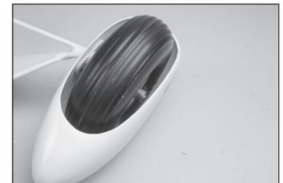
**102.** Serrez la vis de fixation du support de carénage de roue pour fixer le carénage de roue à l'essieu. La ligne de centre du carénage de roue doit être parallèle au bord supérieur du train d'atterrissage.
