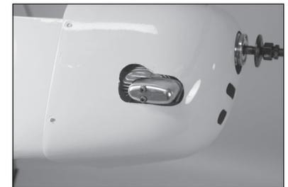
**152.** Fixez l'hélice au bras du moteur. Positionnez le capot de façon à ce qu'il y ait un espace de 3 mm (1/8 po) entre l'hélice et le capot.
