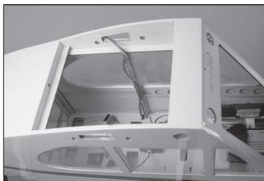
**194.** Collez le(s) siège(s) dans le cockpit à l'aide d'une colle de contact ou d'une bande velcro. Positionnez les sièges entre la batterie et le récepteur.
