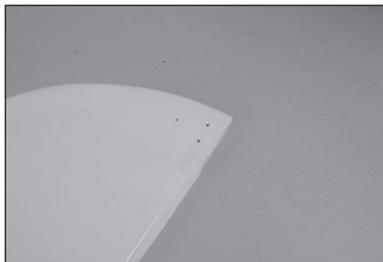
68. Utilisez un couteau avec une lame n° 11 pour séparer la plaque arrière du guignol de commande.
