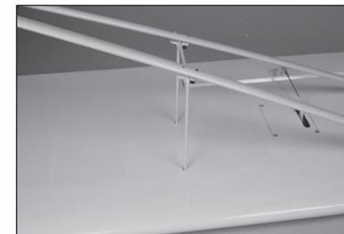
**178.** Ajustez l'extrémité du hauban de manière à ce que le trou sur l'extrémité du hauban soit aligné avec le trou de la languette de fixation. L'extrémité du hauban s'insère sous la languette. Insérez la goupille du côté du fuselage et faites glisser le clip de fixation à travers le trou de la goupille.
