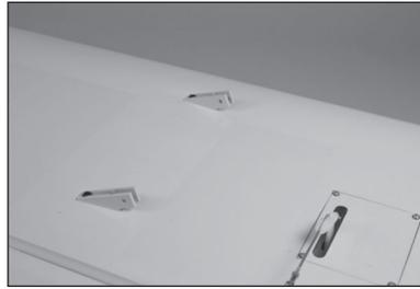
42. Vissez les extrémités des haubans sur les haubans de l'aile. Il y a deux haubans avant (légèrement plus courts) et deux haubans arrière (plus longs) pour chaque panneau d'aile.
