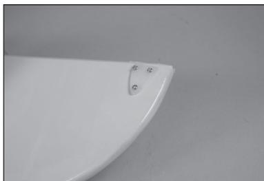
70. Faites glisser le guignol de commande sur les vis, puis fixez le guignol de commande à l'aide de trois écrous M2. Serrez les écrous en évitant d'écraser la structure sous-jacente.
