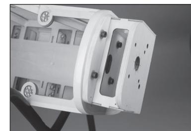
**127.** Utilisez un tournevis cruciforme n° 2 pour serrer le support en X à l'arrière du moteur. Utilisez une clé à six pans de 2,5 mm pour fixer l'adaptateur d'hélice à l'avant du moteur. Utilisez un frein-filet sur toutes les fixations métal-métal pour éviter tout jeu dû aux vibrations.
