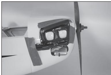
156. Installez le silencieux et raccordez la ligne d'évent à partir du réservoir de carburant. Taillez le capot si nécessaire pour dégager l'espace nécessaire à l'installation du silencieux.
