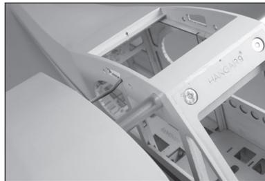
52. Faites glisser fermement le panneau d'aile contre le fuselage, en guidant le fil de l'aileron dans le fuselage. Fixez le panneau d'aile à l'aide de la vis papillon en nylon 1/4-20.
