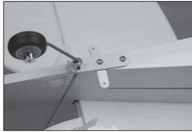
85. Faites glisser la bague contre le support de roue de queue, puis serrez les vis de fixation.
