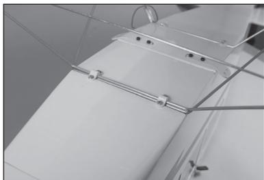
**200.** Repérez les quatre trous pour les sangles du train d'atterrissage sur la partie inférieure du fuselage. Utilisez un couteau et une lame n° 11 pour exposer les trous. Fixez le hauban arrière à l'aide de deux sangles de train d'atterrissage et de quatre vis à tête M3 x 10.
