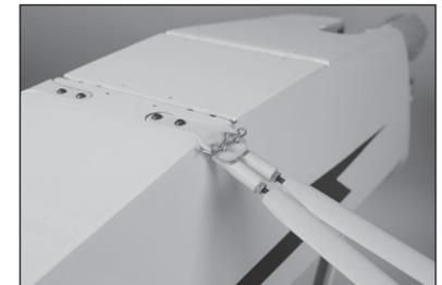
56. Une fois le hauban fixé, utilisez une pince à bec effilé pour serrer les écrous contre les raccords des extrémités du hauban afin d'éviter qu'ils ne se desserrent sous l'effet des vibrations.
