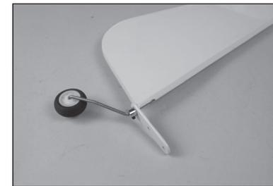
82. Installez le guignol de commande de la gouverne de direction à l'aide de trois vis mécaniques M2 x 15 mm et de trois écrous M2. Suivez les instructions d'installation du guignol de commande de la gouverne de profondeur.
