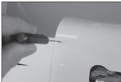
154. Fixez le capot à l'aide de quatre vis à tôle M3 x 10 mm pour fixer le capot au fuselage.
