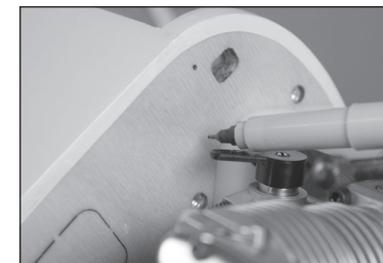
**136.** Retirez le moteur de ses supports. Utilisez une perceuse et une mèche de 3 mm (1/8 po) pour percer les trous pour les vis de montage du moteur. Une fois percé, fixez les supports du moteur au pare-feu.
