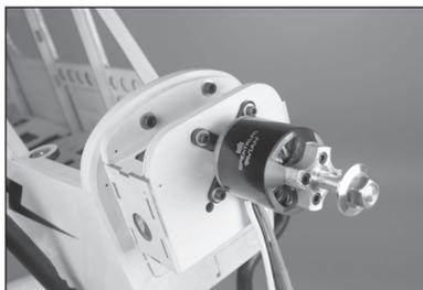
**130.** Acheminez les fils du moteur à l'intérieur du fuselage.
