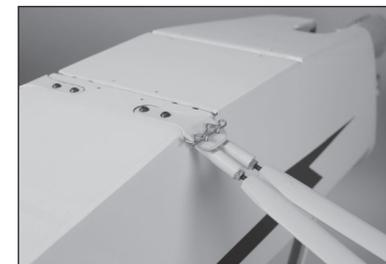
**180.** Une fois le hauban fixé, utilisez une pince à bec effilé pour serrer les écrous contre les raccords des extrémités du hauban afin d'éviter qu'ils ne se desserrent sous l'effet des vibrations.
