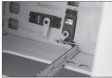
**145.** Vérifiez le fonctionnement du carburateur pour vous assurer qu'il s'ouvre complètement et que la barre de liaison ne se coince pas. Effectuez les ajustements nécessaires au niveau de la tringlerie ou de la programmation radio.
