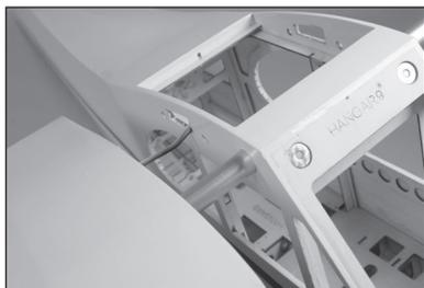
**176.** Faites glisser fermement le panneau d'aile contre le fuselage, en guidant le fil de l'aileron dans le fuselage. Fixez le panneau d'aile à l'aide de la vis papillon en nylon 1/4-20.
