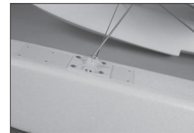
**198.** Utilisez un couteau et une lame n° 11 pour découper une fente dans l'entoilage du hauban arrière. Utilisez un fer d'entoilage pour sceller l'entoilage dans la fente.
