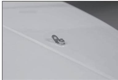
89. Vissez une manille sur le raccord de câble de manière à ce que l'extrémité filetée soit à peine visible entre les fourches de la manille. Préparez les quatre extrémités du raccord de câble.
