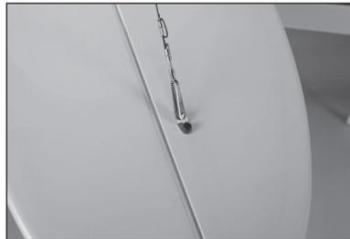
**167.** Fixez les manilles aux languettes situées sur la partie inférieure du stabilisateur. Réglez les manilles de manière à ce qu'il y ait une légère tension sur chaque câble, sans pour autant fausser le positionnement du stabilisateur ou de la dérive.
