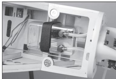
**148.** Raccordez le tube du plongeur au carburateur.
