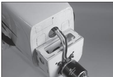
**131.** Branchez les fils entre le variateur ESC et le moteur. Fixez le variateur ESC à l'intérieur du fuselage à l'aide d'une bande velcro.
