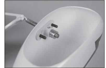
100. Insérez la roue sur l'essieu. L'ensemble peut alors être glissé complètement sur l'essieu.
