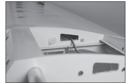
53. Les extrémités de la contrefiche diagonale s'insèrent dans les trous de la face inférieure de l'aile.
