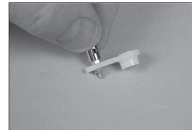
**143.** Ouvrez manuellement le carburateur. Mettez la manette des gaz sur pleins gaz. Serrez la vis de fixation pour fixer la barre de liaison dans le connecteur.
