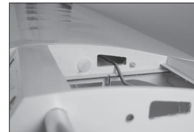
**177.** Les extrémités de la contrefiche diagonale s'insèrent dans les trous de la face inférieure de l'aile.
