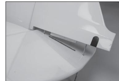
161. Faites glisser les tiges filetées dans le fuselage. Veuillez à guider le support de queue selon les besoins pour mettre en place la dérive et la gouverne de direction.
