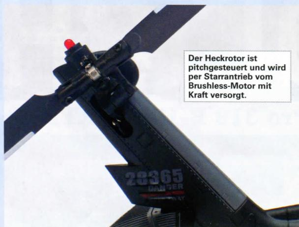
Der Heckrotor ist pitchgesteuert und wird per Starrantrieb vom Brushless-Motor mit Kraft versorgt.
