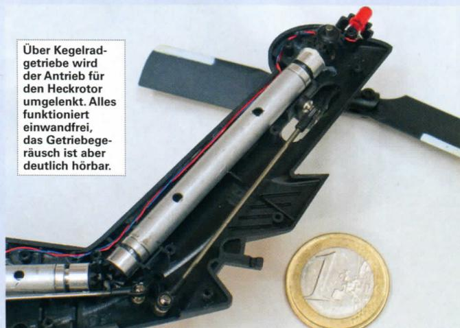
Über Kegelradgetriebe wird der Antrieb für den Heckrotor umgelenkt. Alles funktioniert einwandfrei, das Getriebegeräusch ist aber deutlich hörbar.
