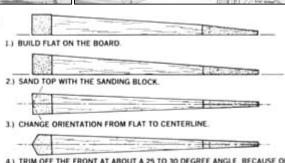
4.) TRIM OFF THE FRONT AT ABOUT A 25 TO 30 DEGREE ANGLE. BECAUSE OF THE CHANGE TO CENTERLINE ORIENTATION. SLIGHTLY MORE MUST BE TRIMMED OFF THE TOP HALF OF THE FRONT THAN THE BOTTOM HALF.
