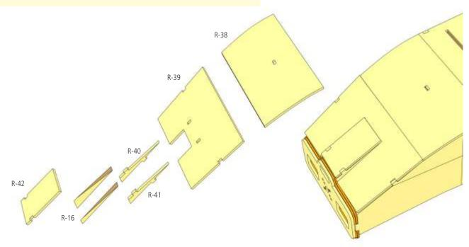
Dreiecksleiste R-16 innen auf rechtes Seitenteil R-43 und linkes Seitenteil R-44 der Kabinenhaube kleben. Die Dreiecksleiste im gekrümmten Bereich ggf. stückeln. R-43 und R-44 zunächst gegen die Kabinenspanten R-45, R-46 kleben, trocknen lassen, dann R-47 einkleben.
