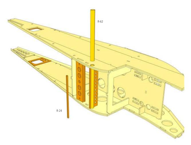
Nun wird das Rumpfheck geschlossen. Die Dreikantleisten im Heck passend zuschleifen, dann Spant R-33 in das Rumpfheck einkleben, mit Nadeln und Klebeband fixieren und gut trocknen lassen. Symmetrie des Rumpfes kontrollieren!
