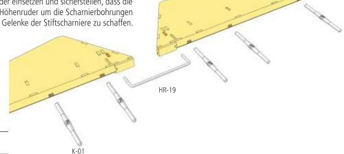
Das Höhenruder provisorisch anschlagen und Beweglichkeit sicherstellen. Dann HR-19 mit Epoxydharz in die Höhenruder einkleben und Ruder endgültig anschlagen. Prüfen, auf welcher Seite sich das Seitenruderhorn befindet, dann Höhenruderhorn HR-18 auf der gegenüberliegenden Seite in das Höhenruder einkleben.
