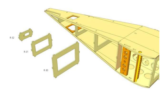
Die Klebeflächen für Rumpfboden und Rumpfdeckel sorgfältig plan schleifen. Dann Rumpfboden und Rumpfdeckel aufkleben, mit Klebeband sichern und gut trocknen lassen.
