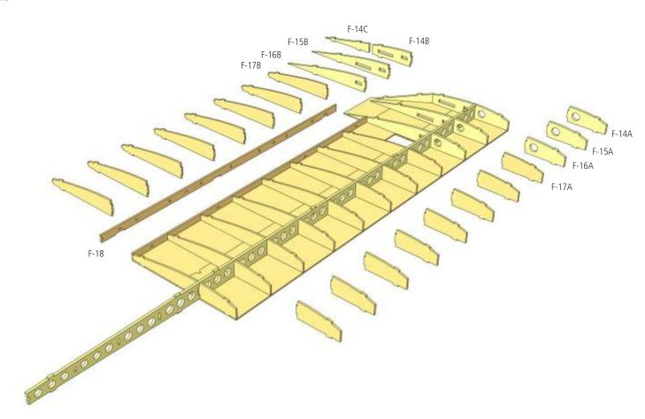
Die Scharnierverstärkungen F-19 und F-20 zwischen die Rippen und von innen gegen den Hilfsholm F-18 kleben. Jeweils zwei Bauteile ergeben eine Verstärkung. Die Flügelsteckung F-23 mit Epoxydharz in die Pappelrippen einkleben.
