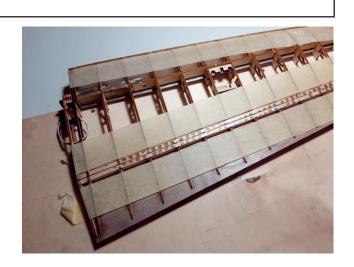
Poncez les deux nervures des volets jusqu'à la hauteur des nervures. Utilisez ici aussi la plaque de ponçage. Lors du ponçage, vous devez faire attention à ne pas enlever la butée du revêtement supérieur sur les nervures. Pour cette raison, poncez uniquement du côté de la latte finale.
