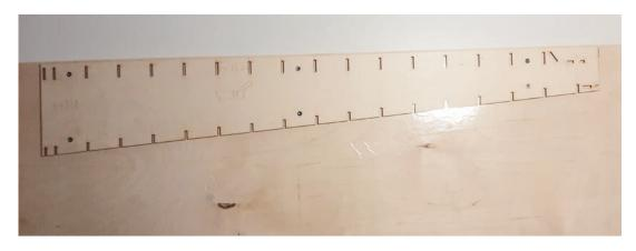
Vous pouvez fixer la cale sur la planche de construction à l'aide de plusieurs vis, d'agrafes ou d'une fine bande adhésive double face. Veillez à ce que la cale soit complètement plane.
