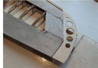
Lorsque tout est en place, retirez à nouveau l'arceau de bord de l'aile et collez l'arceau de bord supérieur en balsa sur le contreplaqué d'avion en le faisant coïncider avec la colle blanche. Veillez à construire l'arc de bord pour le bon côté. Pour que la colle sèche, lestez les deux parties et posez-les sur une surface plane.
