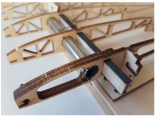
Placez la fixation de la barre de surface dans la nervure 1. Sur la face droite, la découpe pour la barre de surface est à l'avant, l'arrondi du "P" est dirigé vers le haut. L'inscription doit être lisible dans le bon sens. Testez impérativement avant le collage si la barre s'insère sans problème dans la découpe. Maintenant, vous pouvez encore légèrement retoucher.
