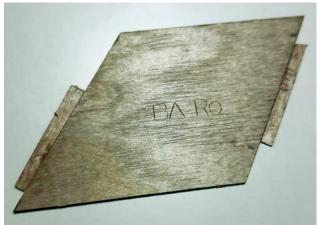
Une fois que les languettes sont collées, tu dois tester une nouvelle fois si le revêtement s'insère dans la zone libre entre le revêtement avant et le revêtement arrière. Tu peux maintenant coller le parement central avec de la colle blanche.
