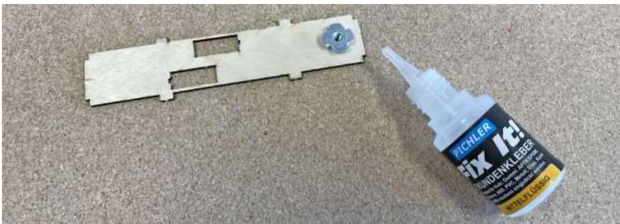
Die Zackenmutter mit mittelflüssigem Sekundenkleber sichern.
