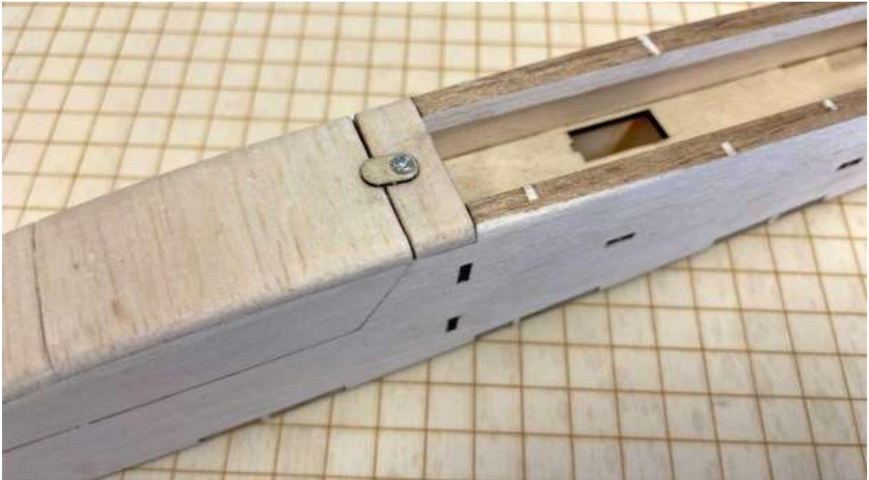
Der Kabinenriegel G1 wird mit einer Schraube fixiert.
