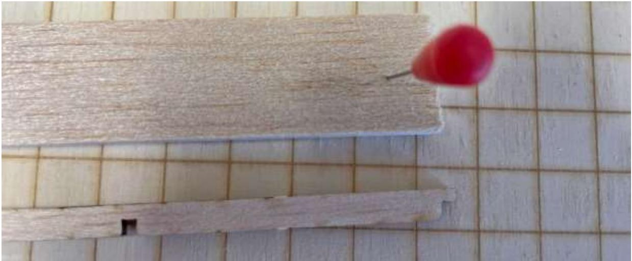
Anschließend die Rippenleiste bündig an die Tragflächenendleiste (lange Dreikantleiste) anleimen.
