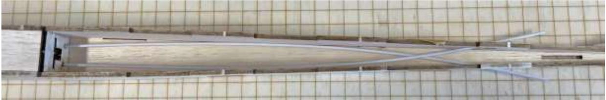
Die Bowdenzugrohre im Rumpf verlegen und an den Ausgängen etwas überstehen lassen.
