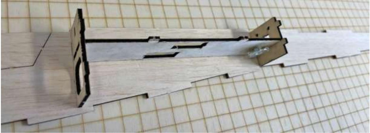
Die Rumpfspanten C1 und C2 sowie das Servobrett C8 wie gezeigt einkleben.
