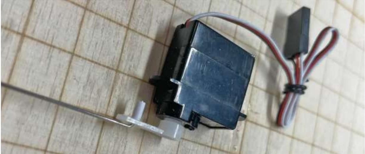
Zur Anlenkung der Ruder dient der beiliegende Stahldraht. Die Enden werden 90° abgewinkelt und mit einem kleinen Stück aufgeklebtem Bowdenzug gesichert.
