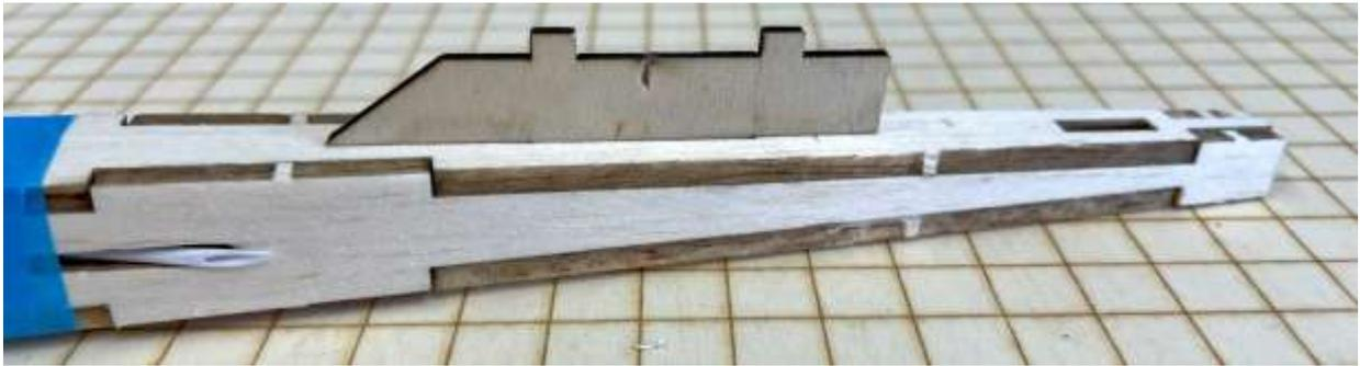
Die Höhenleitwerksauflage C7 wie gezeigt anpassen. Wir empfehlen, dieses Teil erst am Schluss einzukleben, wenn alle Teile des Modells bereits mit Folie bespannt sind.
