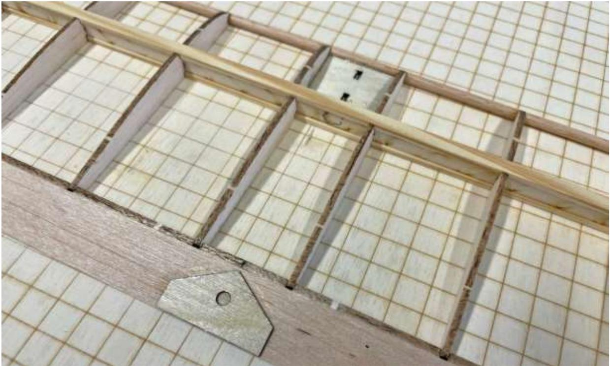
Die Verstärkungsplatte G3 für die Befestigungsschraube wird mittig aufgeklebt.
