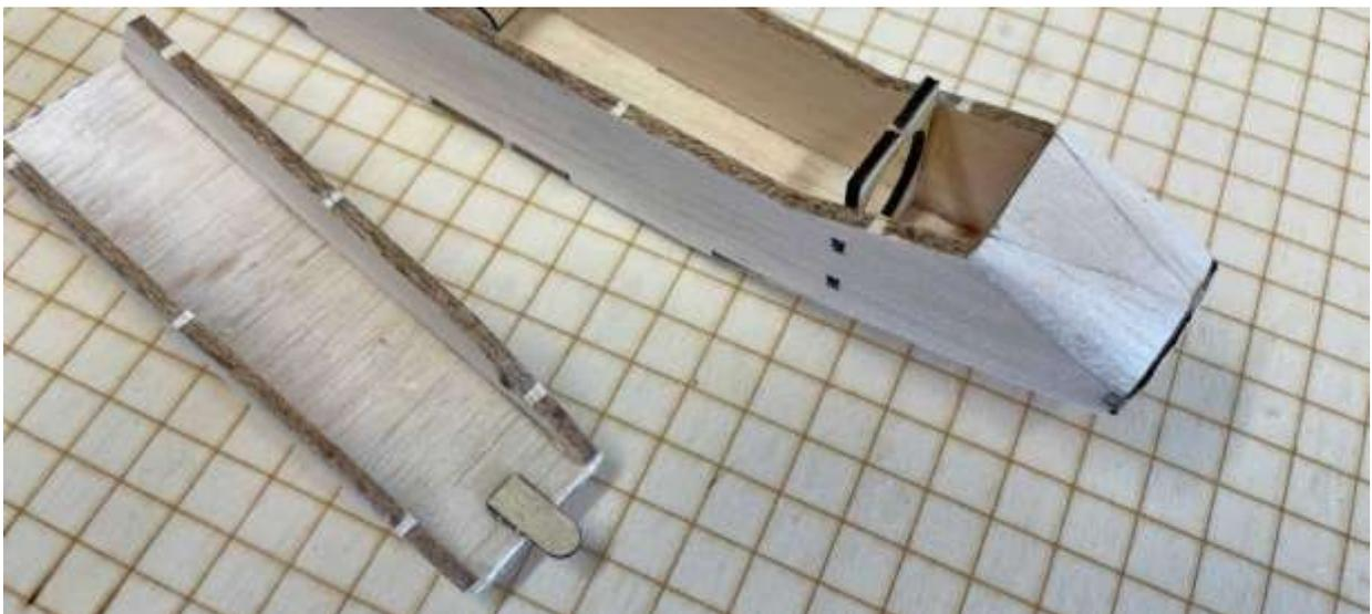
Sperrholzlasche G4 wie gezeigt in die Kabinenhaube kleben. Das Teil B6 von unten mittig etwas einfeilen, damit die Lasche der Kabinenhaube eingeschoben werden kann.
