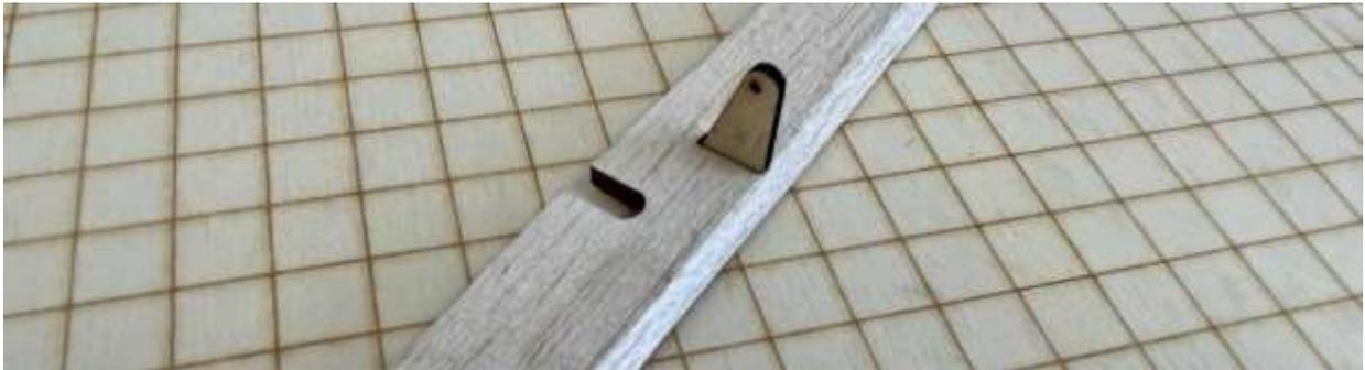
Anschließend das Ruderhorn einpassen. Wir empfehlen, das Ruderhorn erst am Schluss zu verkleben, nachdem alle Teile fertig bespannt wurden.
