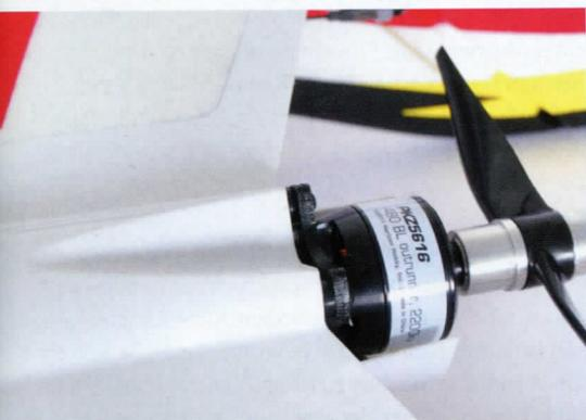
Mit dem verbauten Brushlessmotor sind sehr ansprechende Flugleistungen und lange Flugzeiten möglich
