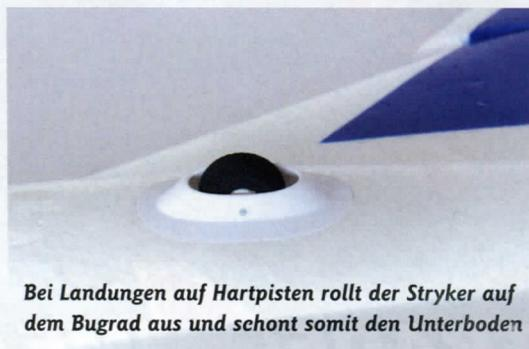
**Bei Landungen auf Hartpisten rollt der Stryker auf dem Bugrad aus und schont somit den Unterboden**
