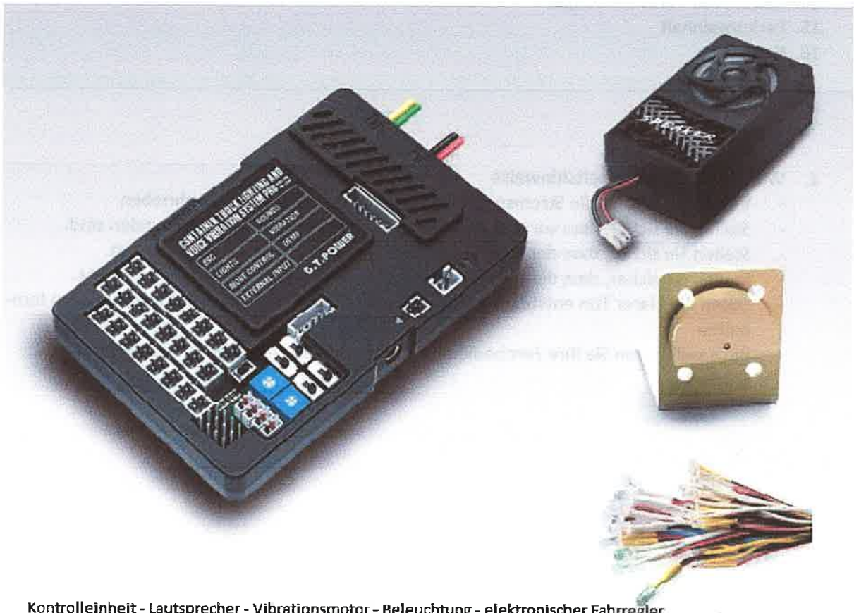
Kontrolleinheit - Lautsprecher - Vibrationsmotor - Beleuchtung - elektronischer Fahrregler
