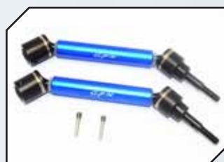
Art.Nr.: GPMTXMS123F/RSAB GPM CVD gehärtet mit Aluminiumwelle v/h blau
