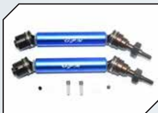
Art.Nr.: GPMSRUS41280FHB GPM Stahl & Aluminiumantriebswelle vorn blau
