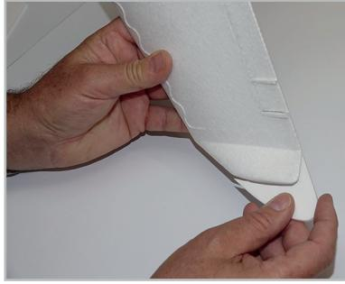
Winglet aufsetzen und halten bis Kleber aushärtet
