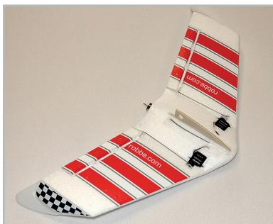
Dekorierte Unterseite mit eingebauten Servos und Antennenkabel
