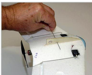
Auswiegen am Schwerpunkt z.B. mit Draht, Büroklammer
