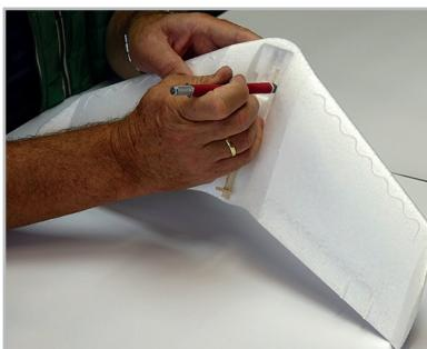
Durchbruch für Servo-Kabel herstellen
