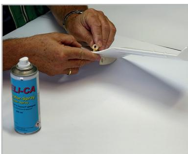
Motor-Halterung in Ausklinkung einfügen ausrichten verkleben
