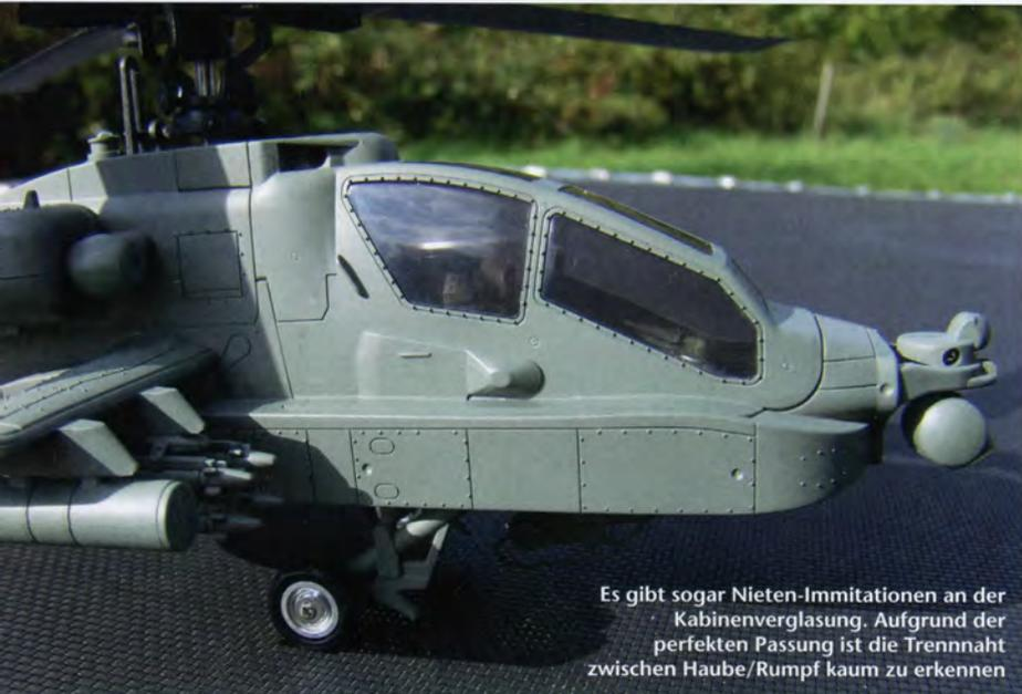
Es gibt sogar Nieten-Imitationen an der Kabinenverglasung. Aufgrund der perfekten Passung ist die Trennnaht zwischen Haube/Rumpf kaum zu erkennen
