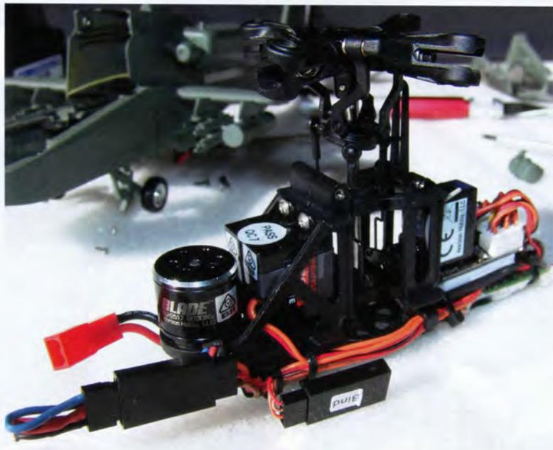
Geregelt werden Haupt- und Heckmotor über den Twin-Controller, der sowohl das Drehzahl-Management des Haupt- als auch des Heckrotors und die BEC-Stromversorgung des Empfängers, der drei Servos und der Positionsleuchten übernimmt.
