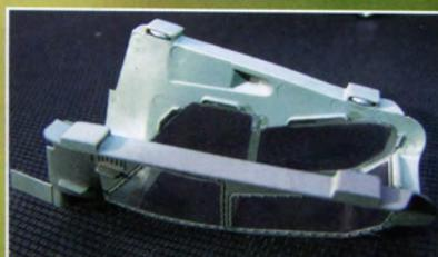
Die Kabinenhaube ist abnehmbar gestaltet und wird mittels Magneten gehalten
