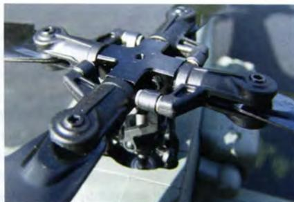
Der linksdrehende Vierblatt-Hauptrotor mit Metall-Zentralstück und Kunststoff-Blatthaltern
