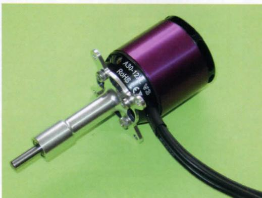
das laute Motorengeräusch, was ja insbesondere für einen Außenläufer untypisch ist. Verantwortlich dafür ist die Wellenverlängerung, die ohne zusätzliches Lager in der Rumpfnase zum Schwingen neigt.
