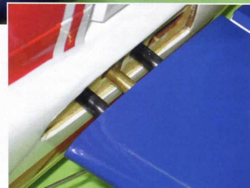
**Um die Leitwerke demontierbar zu machen, wurde ein 4-Millimeter-Goldstecker auf der einen Seite des Leitwerks und ein Messingrohr mit 4 Millimeter Innendurchmesser auf der anderen Seite des Leitwerks in der Wurzelrippe verklebt. Die Klemmung des Goldsteckers reicht aus, um die Leitwerke sicher am Rumpf zu halten**
