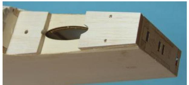
Nun werden die im Bild gezeigten Balsafüllstücke R-20a eingepasst und dem Profil entsprechend ausgeschliffen. Orientieren Sie sich dazu an der Kontur der Rumpfsseitenwände.
