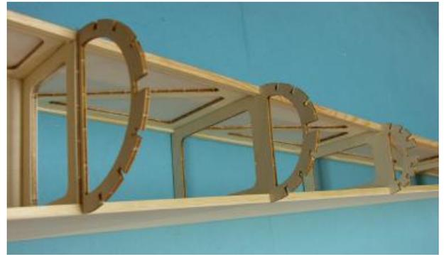
Als nächstes werden der Abschlusspant R-19 sowie die Höhenleitwerksauflage R-20 mit aufgedoppeltem Einsatz R-21 eingeklebt. Passen Sie die Teile sorgfältig ein, bevor Sie kleben. Achten Sie beim Abschlusspant R-19 darauf, dass der aufgelaserte Pfeil nach oben zeigt.
