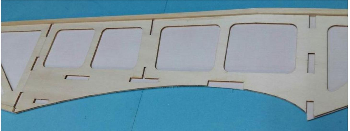
Der kurze Rumpfgurt R-07 wird am Rumpfheck eingeleimt. Er trägt später die Basis für das Höhenleitwerk.
