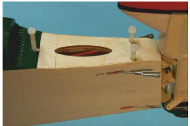
Zuguterletzt wird der Rumpfboden plangeschliffen und mit der Beplankung R-24 verschlossen. Außerdem wird der Motorspant mit den Dreiecksleisten R-25 zu den Seitenwänden hin verstärkt.
