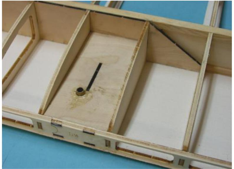
Kleben Sie das Mittelteil (T-27) des Nasenbretts auf die Rippen, gefolgt von den beiden Außenteilen T-28. Stecken Sie die Steckungsrohre T-29 trocken ein.
